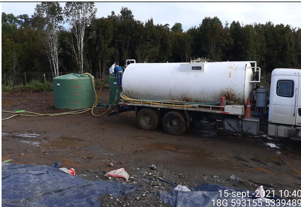
Fotografía N°3: Retiro de Lixiviados desde Estanques de acumulación por Empresa Aconser.
